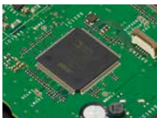
For IF DSP, transmitter ADSP-21363 clock @332MHz
